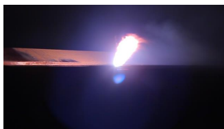
Demo-Bauteil Durchschweißen eines 2mm Blechs im Stumpfstoß mit BrightLine Weld
