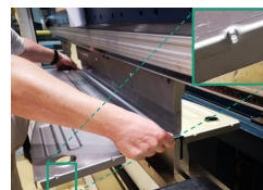
Vorbiegen der Längskanten bis 45°, Detail: Versteifungssicke
