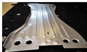
nach roboterbasiertem Rollformen beider Flansche und Kragenziehen
