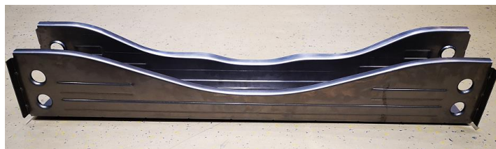
Demonstratorbauteil Querträger 3 nach dem Abkanten
